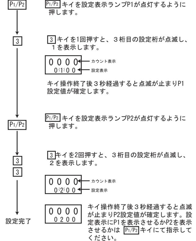
※ **[1] ~ [4]** の桁別キイは、1回押す毎に対応する設定表示の数字を1つつ加算します。また、**[1] ~ [4]** キイを押したままの時にはオートインクリメントにて自動的に数字を加算させることができます。
