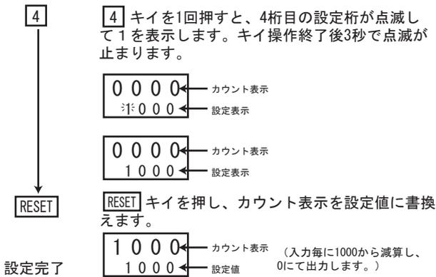
※ **[1] ~ [4]** の桁別キイは、1回押す毎に対応する設定表示の数字を1つつ加算します。また、**[1] ~ [4]** キイを押したままの時にはオートインクリメントにて自動的に数字を加算させることができます。
