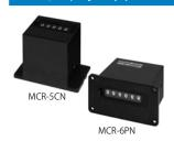
**リセットボタン付きタイプ** / 4桁タイプ・5桁タイプ・6桁タイプ / 最高計数速度: 15Hz 数字高さ: 5.4mm / 各種電圧タイプ (DC24V・AC100V・AC200V)
